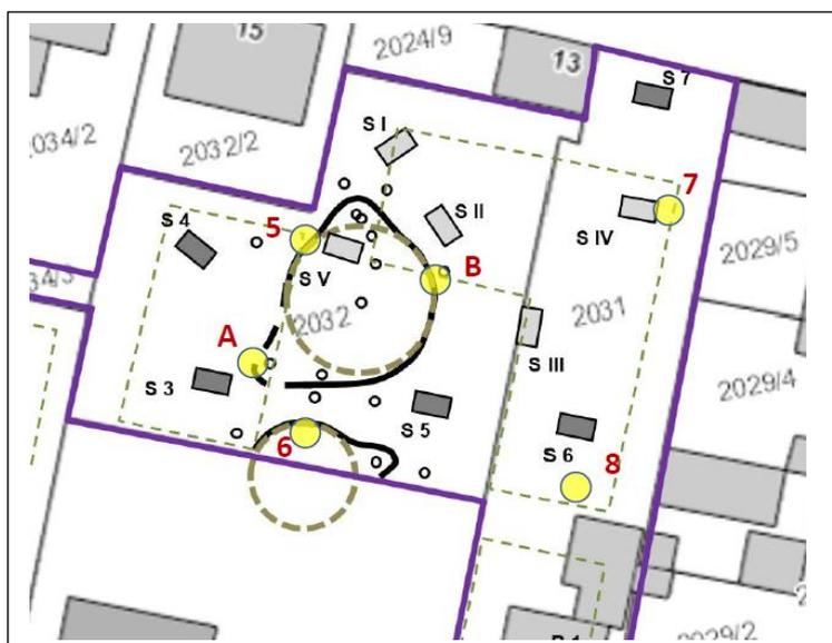
Die Bohrungen haben den Untergrundaufbau aus [11] bestätigt. Die Mächtigkeit der Auffüllungen liegt zwischen 0 und 2,5 m. Darunter folgt natürlicher Lößlehm – ohne erkennbare Verunreinigungen. Dieser reicht bis in eine Tiefe von 7 bis 9,8 m. Darunter findet sich eine hellgrau-grünliche Tonlage (tertiärer Ton), die z.T. unterlagert wird von einer sandig-kiesigen Schicht.
